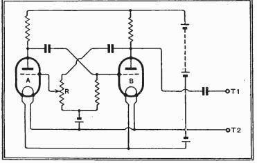
, simple Fig. 1. — 1 ne "multi-vibrator generator.
